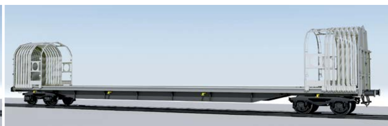
Railway SB • Exemple : Version Rils pour marchandises longues, ouvert (des deux côtés)
